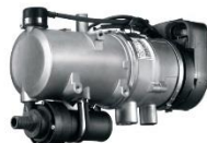
Подогреватель предпусковой дизельный «Webasto»
