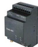
GSM/GPRS модем для контроля работы удаленных объектов
