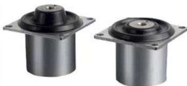
Гидравлические амортизаторы AMC MECANOCAUCHO® имеют усовершенствованное устройство отключения внутри опоры, что предотвращает растягивающую нагрузку на эластомер путем ограничения направленных вверх вибраций. Недавно разработана внутренняя структура вибрационного амортизатора, состоящая из системы металлических деталей. Эластомер вулканизирует все это. Это предотвращает потерю рабочей жидкости в вибрационном амортизаторе, который подвержен большим динамическим перегрузкам.
